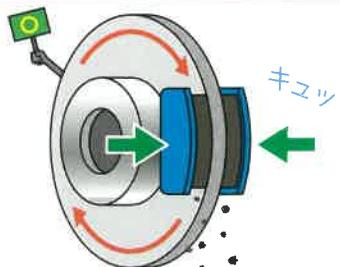
ブレーキ・パッドとロータの摩擦力により
