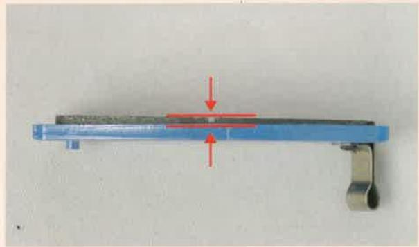
ブレーキ・パッドはタイヤと一緒に回るブレーキ・ロータを挟み込むことによりブレーキを効かせる重要な部品です。ブレーキ・パッドには摩擦材が使用されており、使用するうちに摩耗していき、摩擦材が無くなってしまうとブレーキが不安定になり、ブレーキ・ロータにも損傷を与えてしましますので、摩耗して残量が少なくなっている場合は交換が必要です。
