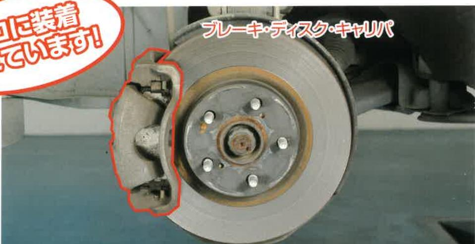
ブレーキ・キャリパ内に装着されていて、タイヤと一緒に回るブレーキ・ロータを挟み込むことによりブレーキを掛けます。
