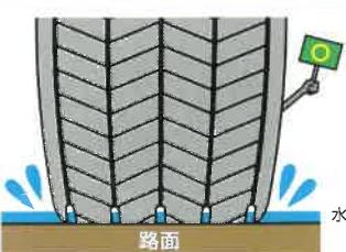
濡れた路面等でも溝で排水し、路面に接地できる。
