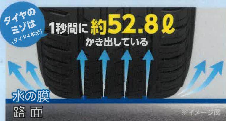
クルマが雨の日にしっかりとブレーキで止まり、コーナーを不安なく曲がれるのは、タイヤの溝が地面とタイヤの間の水を大量にかき出しているからです。
