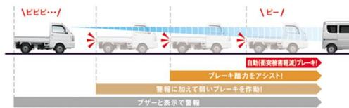
※自動(衝突被害軽減)ブレーキ機能作動時は強いブレーキがかかりますので、走行中に全ての乗員が適切にシートベルトを着用していることをご確認ください。※自動(衝突被害軽減)ブレーキ機能作動後は、クランプ現象により前進しますので、必ずブレーキペダルを踏んでください。
