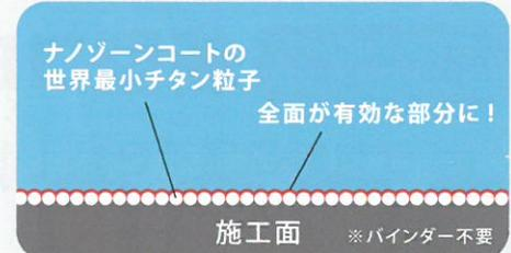
噴霧するだけで散布面の分子に直接結合。拭き取っても落ちないので効果も持続。接着剤がないので、劣化せず、広い表面積で十分に効果を発揮。
