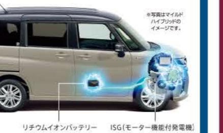
リチウムイオンバッテリー ISG(モーター機能付発電機)
