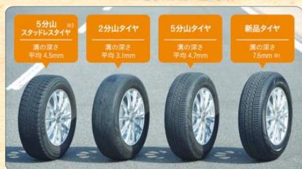
※1 溝の深さはタイヤの縦断面中央で計測。タイヤの山は新品の溝の深さから使用距離1.6kmを引いた数値を100山として計算。
