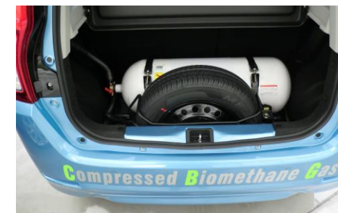
ワゴンRのトランクに搭載のCNGタンク
