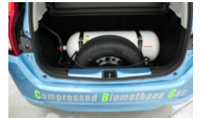
ワゴンRのトランクに搭載のCNGタンク
