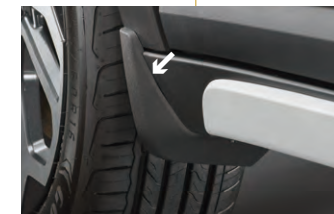
マッドフラップセット 砂や泥などの跳ね上げによる車体への傷や汚れを軽減。
