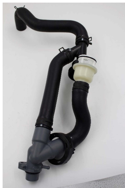
マイクロプラスチック回収装置を搭載した船外機(左)、および回収装置(右)
