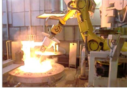
鑄鉄溶解炉におけるノロ取りロボット
