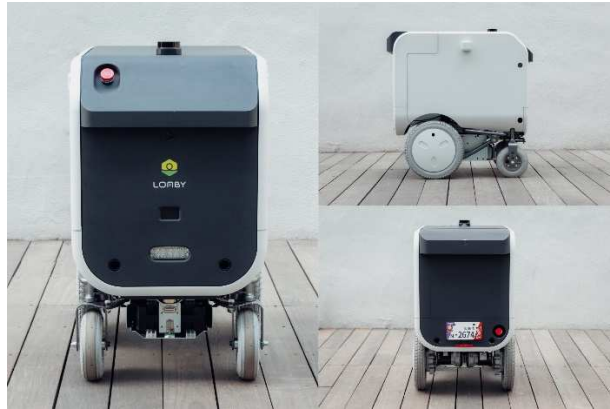
電動車いすの台車を用いた自動配送ロボットの試作車
