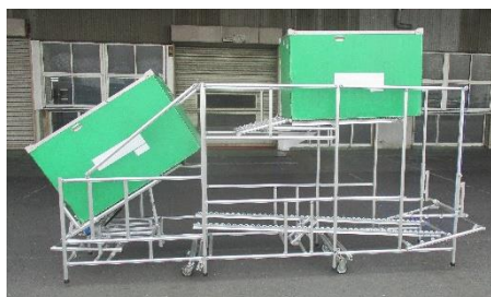
作品名「衝 nothing」 部品箱交換時に発する騒音・衝撃緩和 と作業時間を削減した部品供給ラック
