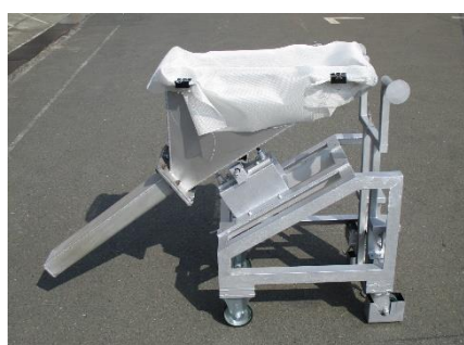
作品名「樋・ストーリー」 注湯時に高温の台車から身体を離して 移動することで安全を確保した台車
