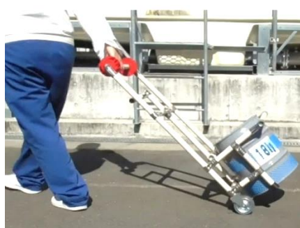
作品名「てこてこキャリイ」 18 kgのペール缶を運搬する時に、缶 に触れず、積載→運搬→降ろしを可能 にした運搬具
