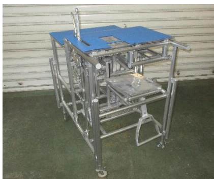
作品名「おふくろキャッチャー」 袋詰めと袋とじ作業を簡略化した装置
