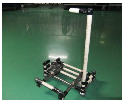
作品名「どっちに行きまSHOW」 狭い場所でも台車の固定輪を浮かせる ことで、前後左右の移動を可能にし た台車
