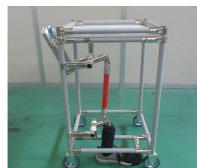
作品名「靴いっちゃってドキ♡同期♡台車」 ハンドル操作ひとつで、コンベアーとの 同期と解除を可能にした台車
