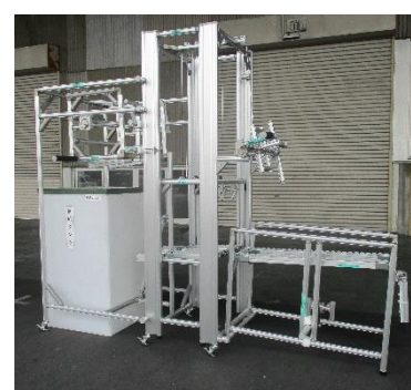
作品名「流して あげて クルりんボーイ」 液体薬品補給時の重筋作業軽減と 作業時間を削減した装置
