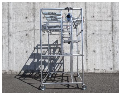
作品名「簡単楽ちん空箱回収」 空箱回収時に負荷の掛かる作業姿勢 の見直しによる安全性と作業効率を 向上した装置
