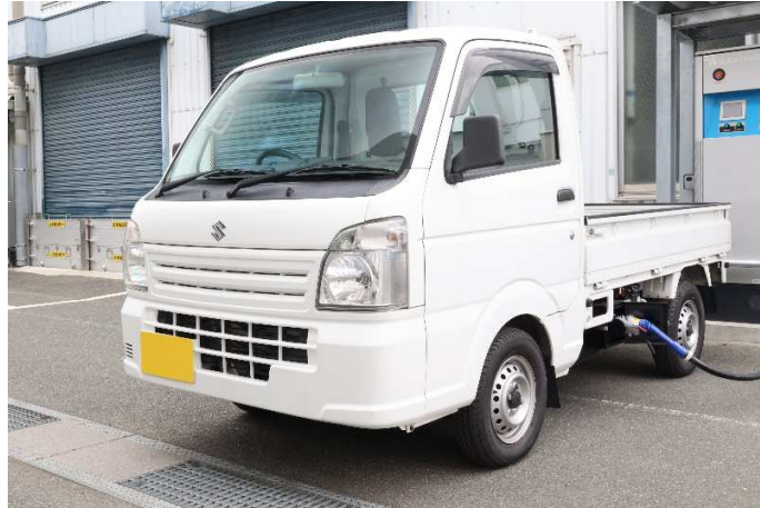
実証実験用に製作した BEV 軽トラック
