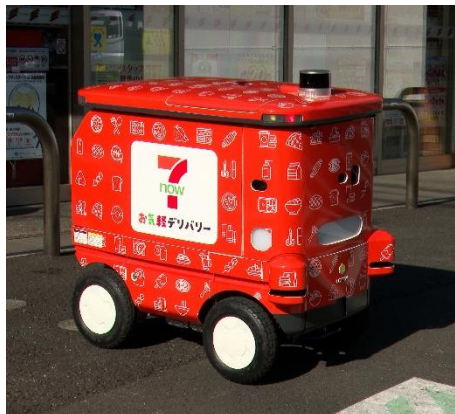
※実証実験に使用する屋外用ロボット
