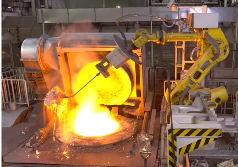
スズキ株式会社は、鋳造工程における鋳鉄の溶解時に発生する不純物（ノロ）の除去作業工程の自動化に関する技術について、草野産業株式会社（本社：東京都中央区、代表取締役：草野惣一郎、以下「草野産業」）よりスズキ保有の特許等使用の申し出を受け、このたびライセンス契約を締結しました。なお、草野産業はこの技術を活用した設備（設備名称：SMART「Suzuki Melting process All operation Robot Technology」）を販売します。
