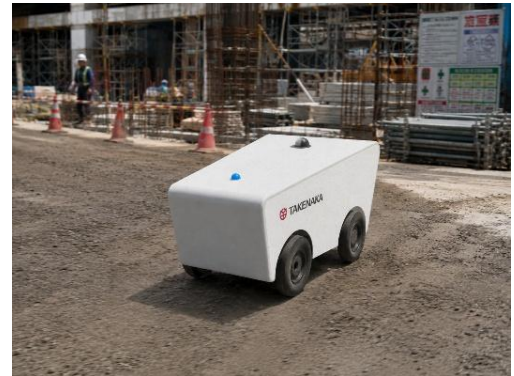
アダワークスジャパン株式会社 「建設現場用 遠隔監視ロボット」
