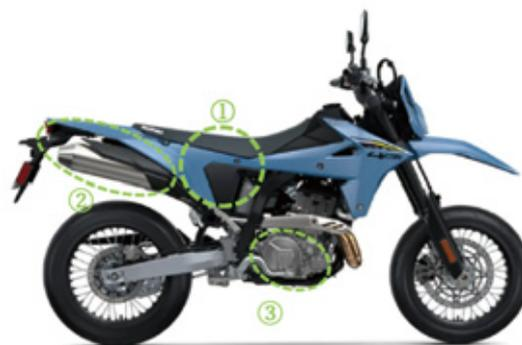
①エアリーナは、十分な容量を確保し吸気音の低減を図ると共に、両サイドケース内壁にリブを配置して剛性を高めることで壁面からの放射音の低減を図りました。
