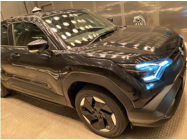
「eビターラ」車室内VOC測定の様子
