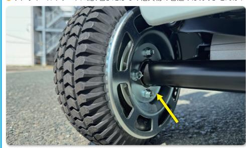
1度でも脱輪して衝撃を受けたサブホイールプレートはそのまま使用せず交換してください。
