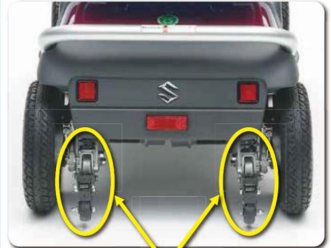
矢印で示した補助輪の損傷を確認してください。
