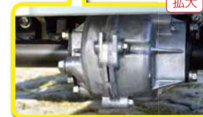
シート下の車体下部に、オイル漏れや異常なサビ、ボルトの欠損等の損傷がないか確認してください。
